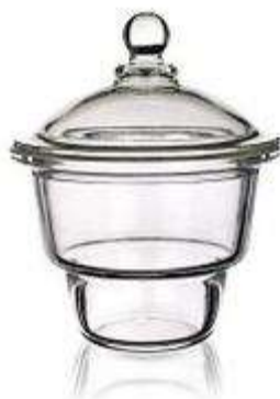
DI60743526391414 Эксикатор Dinkelberg со стеклянной крышкой, DIN 300 мм
